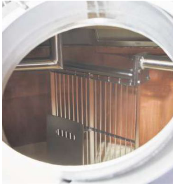
Die Heumilch kommt zunächst in den Fertiger, wo sie mit Sirtenkulturen und Lab vermischt wird.
