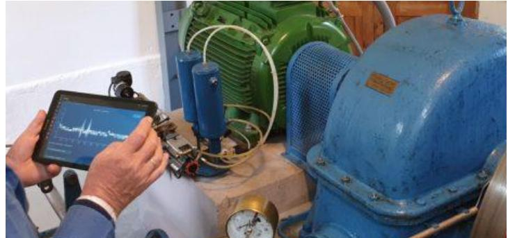
Intelligentes **Anlagentuning** umfasst neben der fachkundigen visuellen Beobachtung auch die Analyse aus den Daten der Maschinensteuerung und wertet diese aus. In Summe entsteht ein umfänglicher Blick auf den Istzustand der Maschine oder Anlage und dadurch eine optimale Basis für das Planen zielgerichteter Wartungseinsätze. Durch die automatisierte Maschinendatenaufzeichnung werden mittels Trendanalysen Abweichungen vom Normalzustand frühzeitig erkannt.
